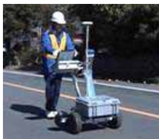
PS 衛星電波で埋設管の探査データの位置を確定
